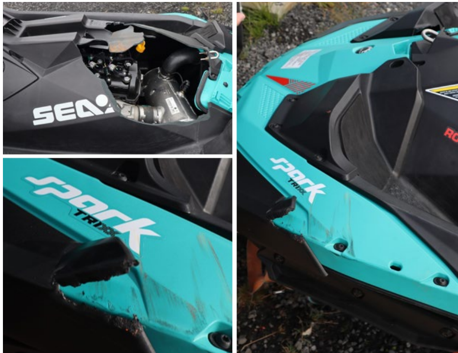
Mynd 4 Skemmdir á sæpotunni og ákoman eftir áreksturinn stjórnborðsmegin á skut
